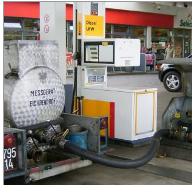
Kontrolle einer Betriebsstoffmessanlage
